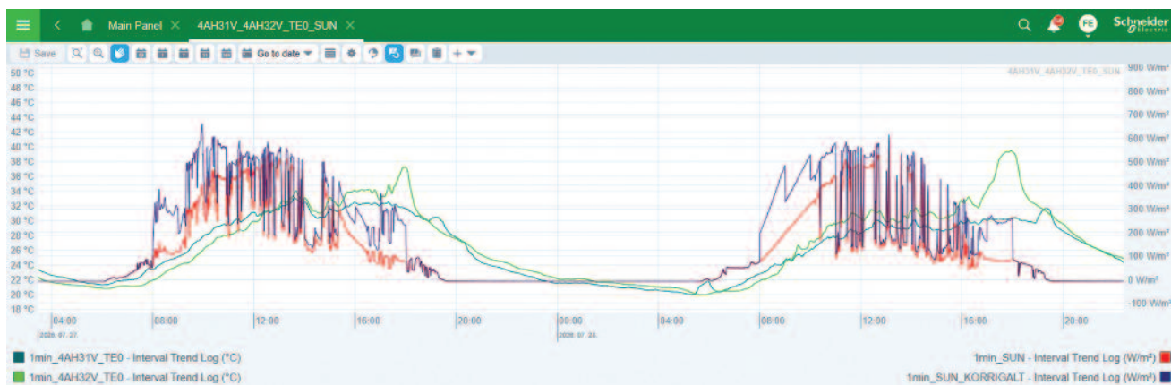
3. ábra: Napsugárzás-intenzitás és külső hőmérséklet trendje (A zöld vonal mutatja a hőmérséklet-változást, a piros a sugárzásintenzitást, a lila szín pedig a korrigált sugárzásintenzitás változását. Forrás: DH Zrt., távfelügyelet)
