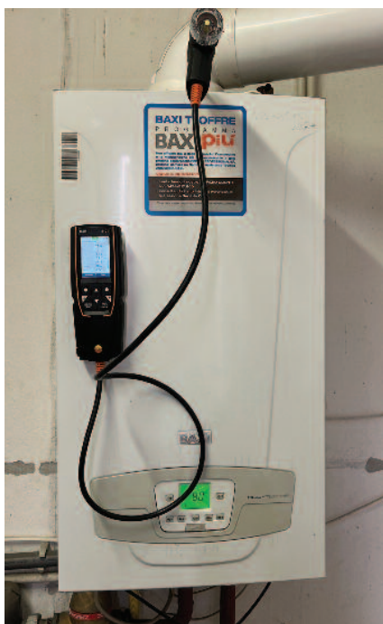
1. kép: Az égéstermék-veszteség mérése
