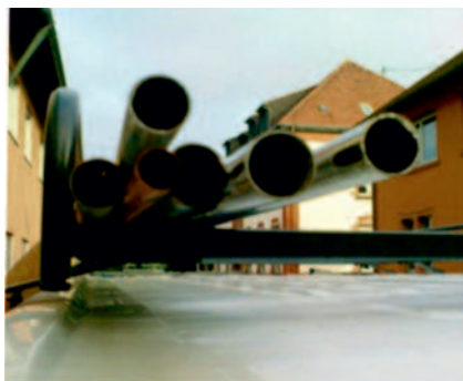
12. kép – A fémcsövek „ledugózás” nél-küli szállítása korrózióvesztélyt rejt magában
