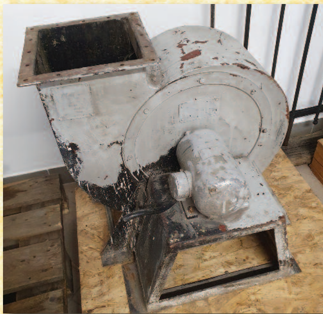
Sok lángos olajgőzét szívta el ez a centrifugál ventilátor
