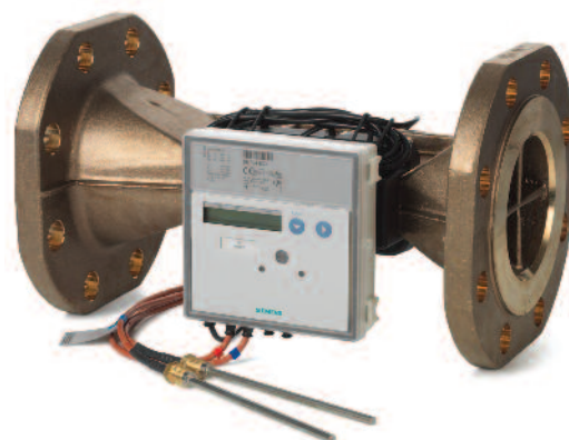
3. kép – Siemens UH50-C74 ultrahangos, közületi, fűtési/hűtési hőmennyiségmérő MBus/rádiós/Modbus stb. kommunikációs modul lehetőségeivel
