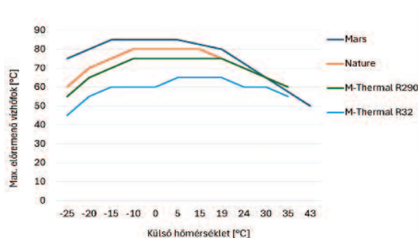
4. ábra – Legnagyobb előremenő hőmérsékletek a külső hőmérséklet függvényében a Midea hőszivattyúknál
