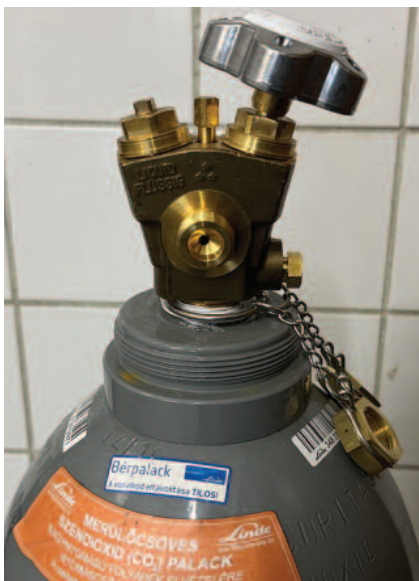
Szén-dioxid-palack biztonsági szeleppel (Forrás: Linde)
