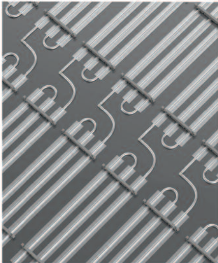
5. kép – Teljes egészében alumínium rendszer, alu hőátadó lemezekkel, csővel
