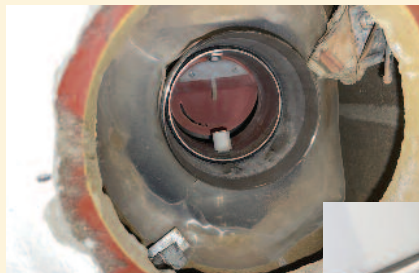
2. kép – Tömörtelen füstgázcsappantyú. Tömörnek szánt csappantyú esetében az alkalmazott anyagoknak megfelelőeknek kell lenniük. A szilikon savas közegnek nagyon rövid ideig áll ellen, így hetek alatt a képen látható előregedés, tömörtelenség alakulhat ki
